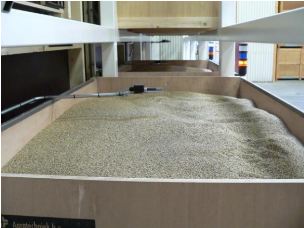
Les conditions de l'air ( T^\circ et HR) sortant de la semence sont mesurées pour chaque palox.
