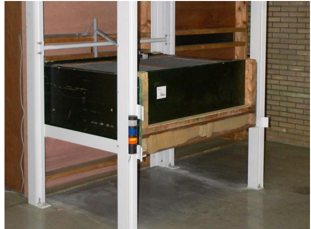
Un éclairage «LED» procure une indication de statut du processus de séchage. Orange = Début de séchage; Bleu = Dernière phase; Blanc = Séchage terminé.
