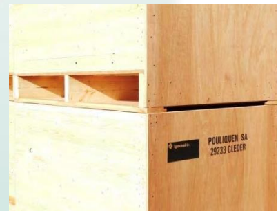
Dieser Unterschied sorgt für eine Öffnung zwischen den Kisten. Dadurch kann die feuchte Luft entweichen.
