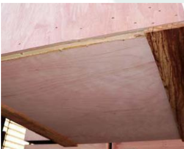
Der Kistenboden wird mit 9 mm Multiplex verschlossen.
