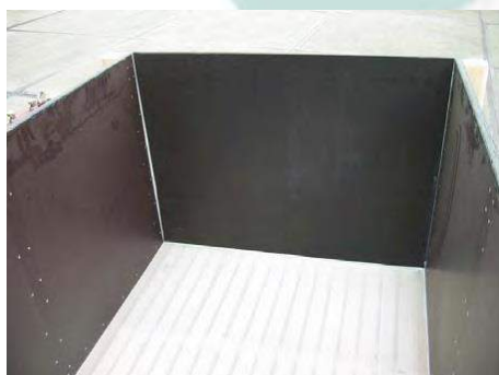
Caja de secado con suelo de listones y una malla fina encima de él.
