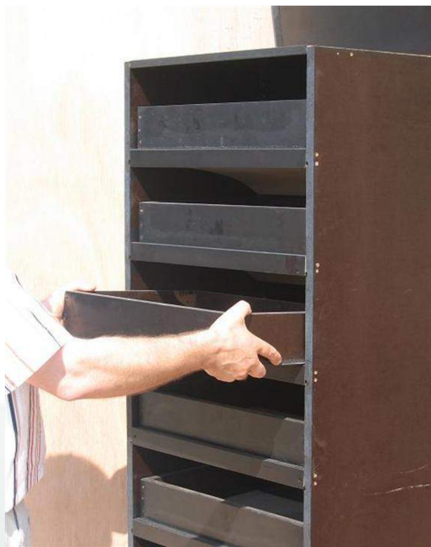
Entrada de aire se abre cuando se coloca el cajón.
