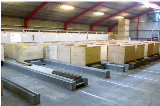
La instalación de secado antes de modificación; hay un ventilador por fila de cajas
