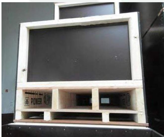
Ejemplo de caja de secado con doble palets: ventilación y transporte. Caja de contrachapado con recubrimiento.
