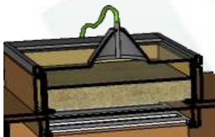
El sensor de medición de T°+HR (c) ha sido montado a la rejilla cubierta con un embudo para medir las condiciones del aire de la semilla.
