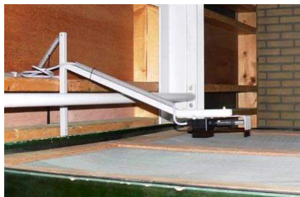
Sensor en el flujo de aire extraído de una caja de secado. Medida de Temp. y HR por sección. (caja, bandeja, contenedor).
