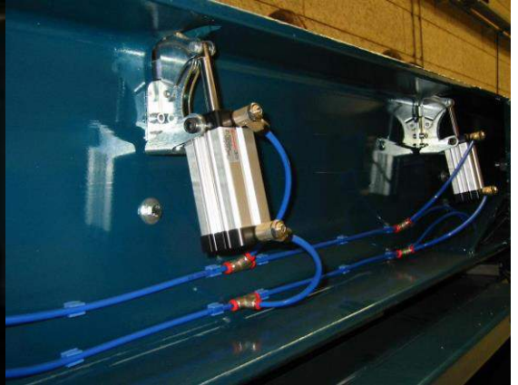
Los cilindros neumáticos cierran los tamices automáticamente en el marco de tamiz.
