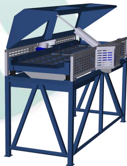
Pequeña calibradora de pantalla plana (400 mm de anchura) para 3 fracciones. Usada para la limpieza de semilla y gránulos en laboratorios.
