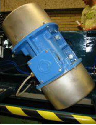
Dos motores vibratorios están instalados encima del marco de tamiz.
