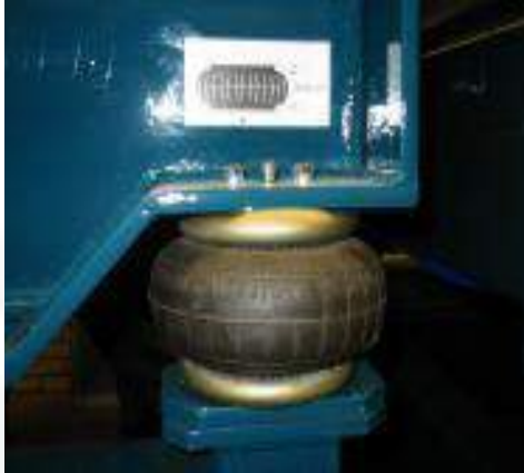
El marco de tamiz está instalado encima de cuatro amortiguadores de aire.
