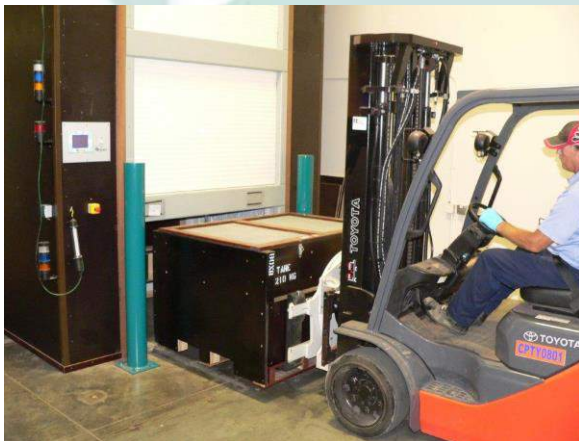
Caja de secado con semilla está colocada dentro de la unidad de secado
