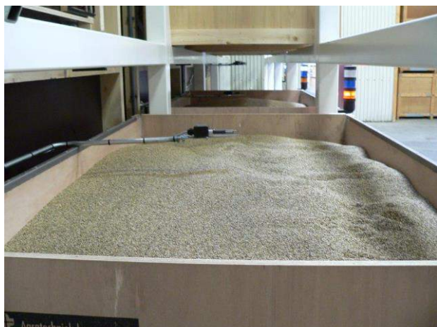
De conditie ( T^\circ en RV) van de lucht uit het zaad wordt bij elke kist gemeten.
