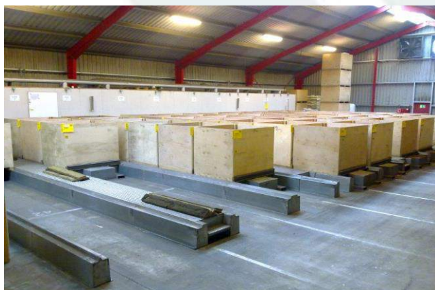
Drooginstallatie voor de aanpassing; per rij kisten een ventilator.
