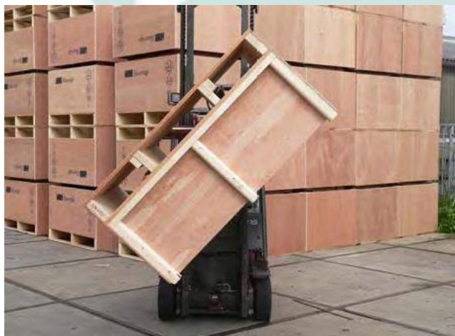
Voorziening in pallet maakt kantelen met heftruck eenvoudig en veilig.
