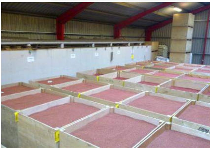
Bestaande installatie voor drogen van gecoat zaad in kisten (10 secties)
