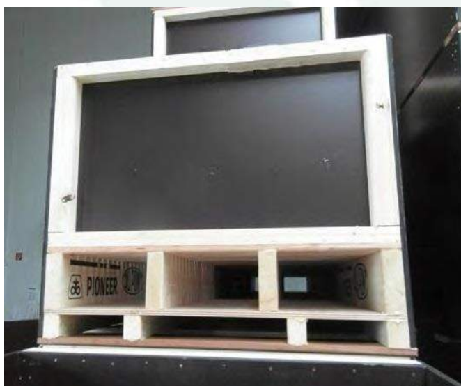
Voorbeeld van een droogkist met dubbele pallet: Ventilatie en transport. Kist met een betonplex buitenkant.
