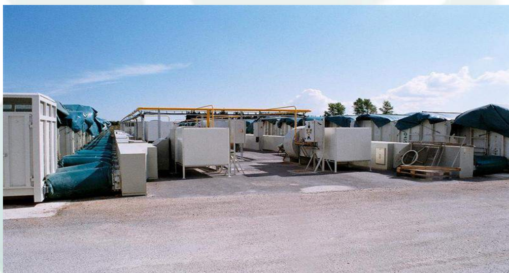
Droogsecties met ventilator, luchtverdeelkanaal en aansluitingen naar de containers
