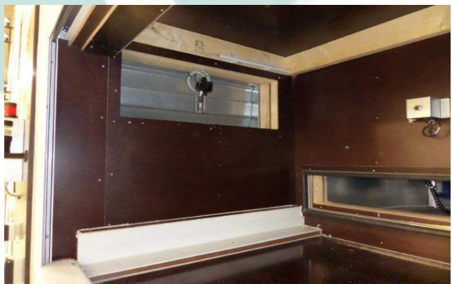
Uitlaat met T°+RV sensor om het proces te meten.
