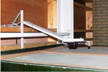
Sensoren bij lucht uit het product. Meting RV en T^\circ per sectie / kist / bak / container
