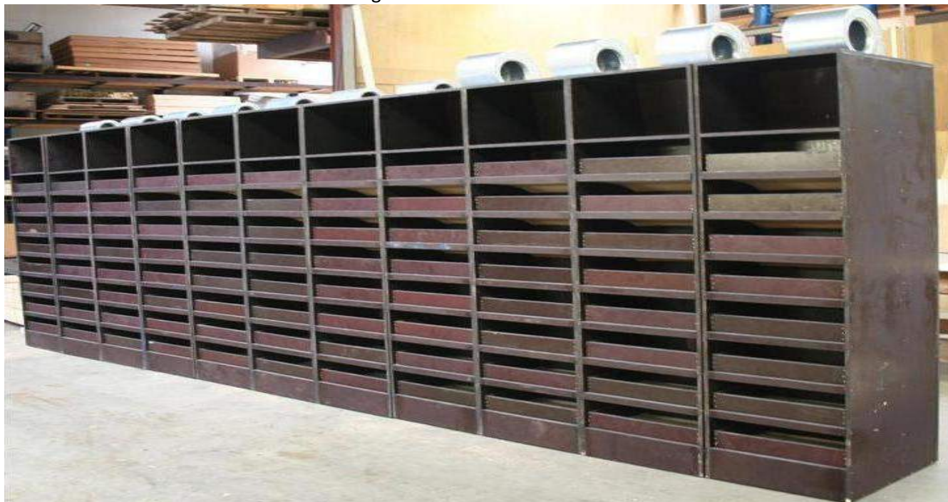
Drooginstallatie bestaande uit verschillende units met laden.
