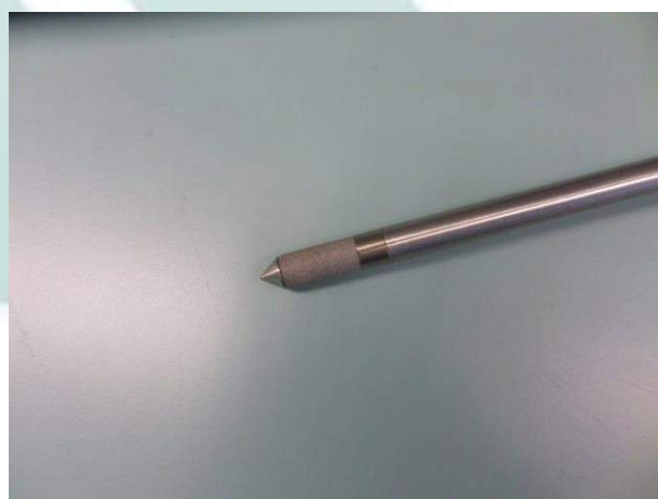
Meting van RV+T° bij de punt van de sensor
