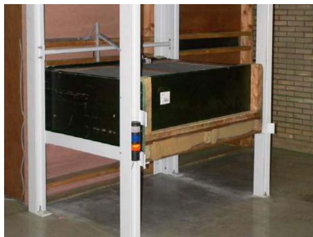
Ledlampen geven een indicatiestatus van het droogproces. Oranje: start droging, blauw: laatste fase, wit: droging gereed.
