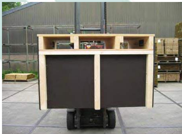
Kist kan tussen de liggers niet bewegen, de pallet raakt niet beschadigd. Zaad stroomt vloeiend.
