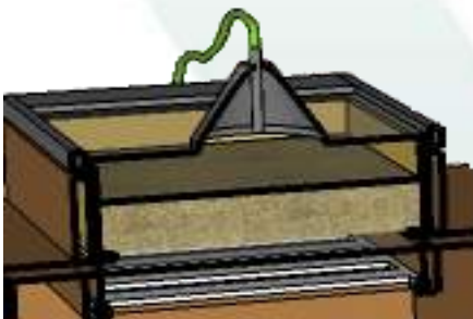
De T°+RV meetsensor (c) is met een trechter gemonteerd op het afdekrooster om de conditie van de lucht uit het zaad te meten.
