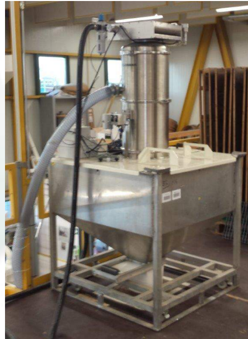
Hopper van een vacuüm systeem vult de doseerkist continu.
