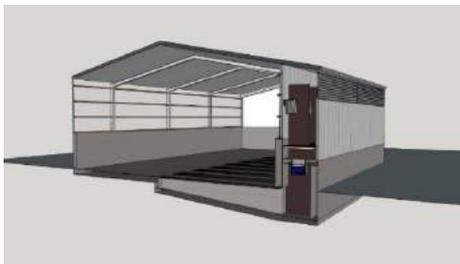
Posizionando un riscaldamento modulare per ciascuna fila, è possibile adattare la temperatura alla fase di essiccazione; all'inizio un riscaldamento progressivo e successivamente essiccazione ottimale con una temperatura desiderata. Poiché anche la quantità d'aria è variabile, spesso vengono installati 2 piccoli bruciatori a gas per avere una maggiore differenza tra la capacità minima (1 bruciatore basso) e massima (2 bruciatori alti).
