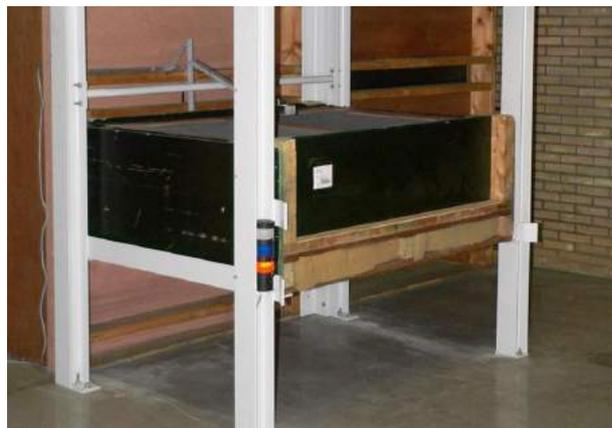
Delle lampadine led indicano lo stato di avanzamento del processo di essiccazione.
