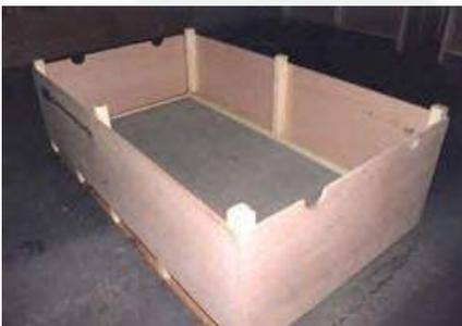
Sostegni angolari e fissaggi interni comportano giunture e fessure in cui le sementi possono infilarsi e questo richiede una maggiore pulizia e controllo per evitare il mischiarsi di semi.
