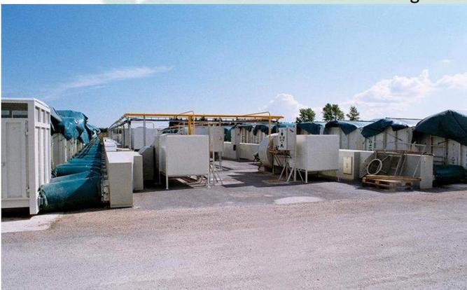
Esempio di essiccazione in container di essiccazione. La quantità di aria viene modificata in base al numero di container.
