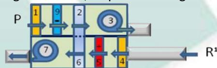
**Opzione II) 9:** Batterie con acqua fredda (chiller) con capacità modulabile per raffreddare l'aria del processo a qualsiasi temperatura T°C desiderata. Sistema ibrido
