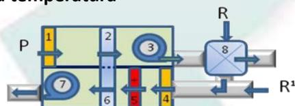
**Opzione I) 8:** Lo scambiatore di calore abbassa la T° di processo fino al livello ambiente di + 3°C. L'energia liberata viene utilizzata per riscaldare l'aria per la rigenerazione; Risparmio energetico.
