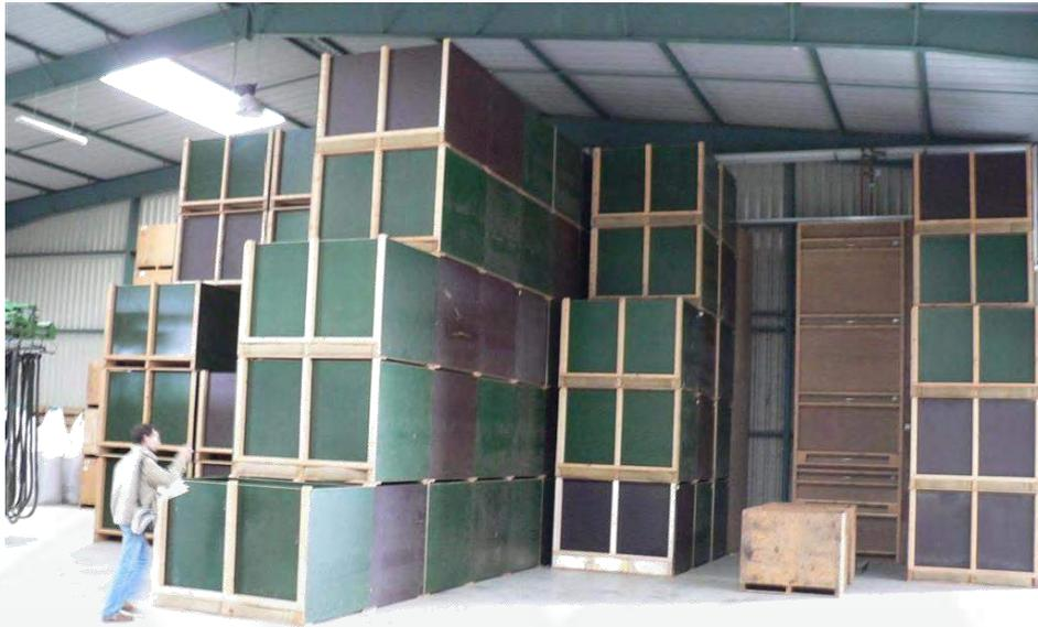
Essiccazione efficiente delle sementi in cassoni muniti di processori per l'essiccazione automatica al livello di umidità richiesto. Pile di 2-3-4-5 o 6 cassoni. Sfruttando l'altezza si crea un volume di essiccazione massimo per una superficie minima e quindi maggiore capacità di essiccazione!
