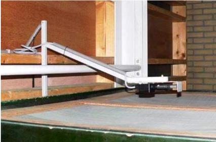
Sensori per l'aria di uscita dal prodotto. Misurazione di UR e T° per sezione/ cassone/ contenitore/ container
