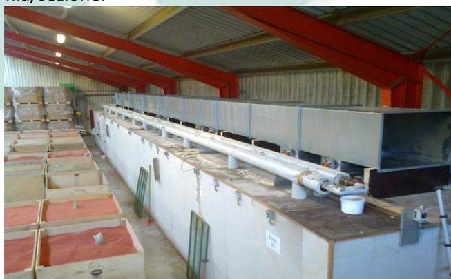
Canale di distribuzione dell'aria sopra gli aeratori a lamelle. Aria secca dall'essiccatore verso ogni sezione.
