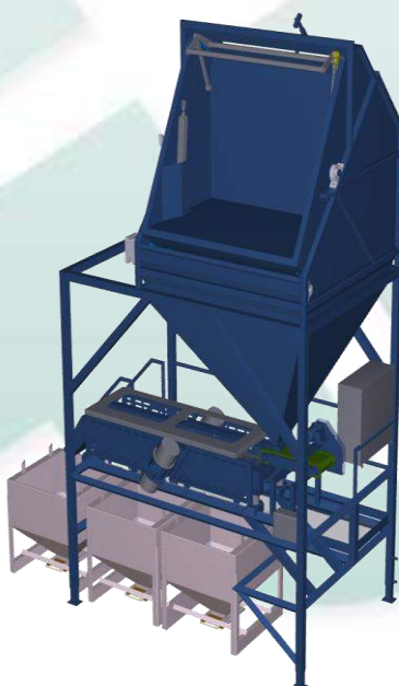
Dal cassone tramite il deposito e il nastro dosatore verso una piccola unità di calibrazione-setacciamento. Il giusto dosaggio è garantito!
