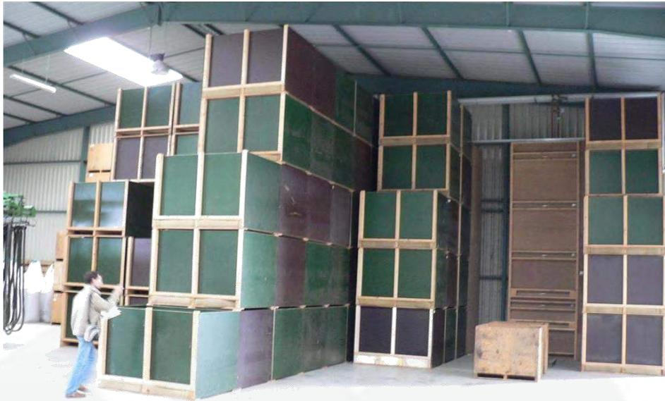
Séchage en palox automatique avec processeur, principe palox pour ventilation par niveau individuel. Empilement de 2-3-4-5 ou 6 palox. L'ouverture en façade correspond aux dimensions de la palette. Pour une occupation efficace de votre surface et du volume de votre bâtiment.
