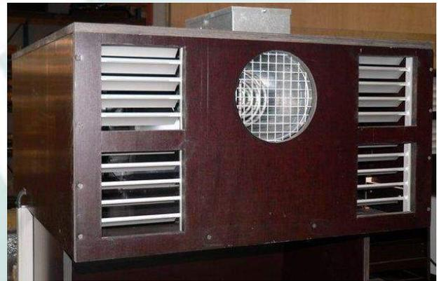
Unité d'aspiration avec chauffage et clapets.
