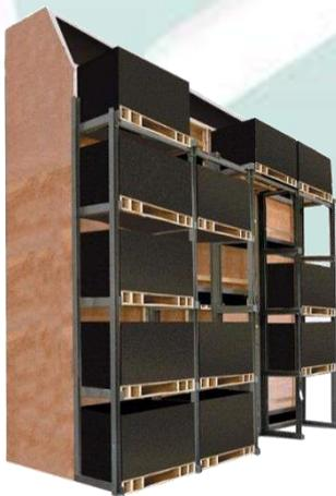
Les palox sont déposés dans l'échafaudage devant l'installation de séchage. Le palox peut être déposé dans n'importe quel emplacement et enlevé lorsque la semence dans le palox est sèche.
