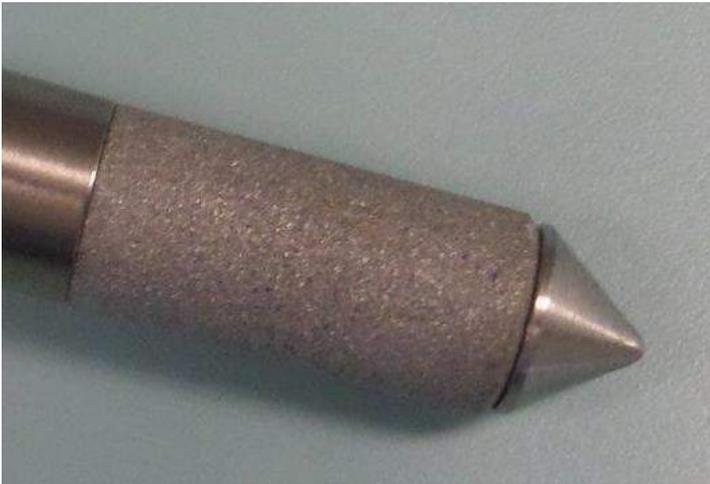
L'extrémité de la tige est équipée d'une double sonde électronique de T° et d'HR et protégée par un fin filtre d'acier inoxydable. Une pointe émoussée permet à la sonde de pénétrer facilement et sans dommage dans la semence.
