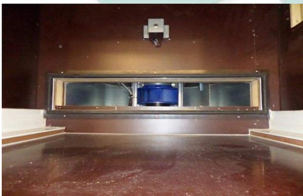
Un ventilateur haute pression avec une sonde de «Flux» pour chaque emplacement.
