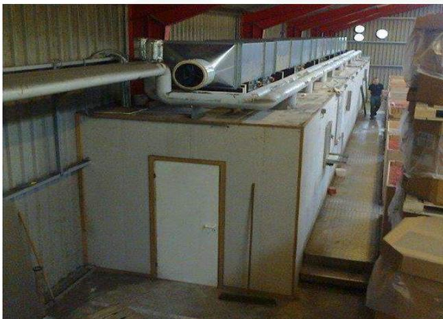
Les installations de séchage existantes peuvent être équipées d'une gaine de répartition d'air séché.
