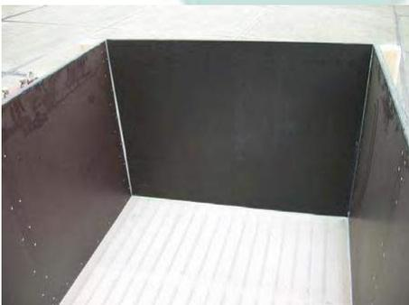
Palox de séchage avec fond à lattes recouvert td'une toile métallique.
