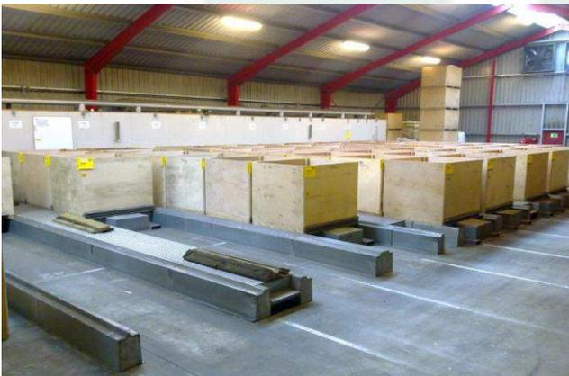
L'installation de séchage avant l'optimisation; Un ventilateur, par rangée de caisses.
