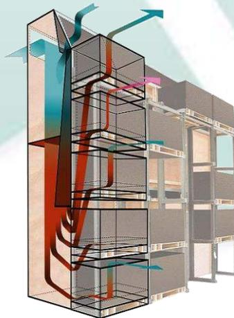
L'air aspiré, intérieur ou extérieur est réchauffé et éventuellement complété avec de l'air sec. La juste quantité d'air est soufflée à travers chaque palox.
