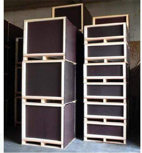
Palox de séchage à bords hauts pour dessemences «grossières» ou plantes entières. Palox pour de la semence «fine» ; hauteur 2/3 (en haut) ou demi palox (à droite). Pieds et renforts à l'extérieur. Moins decoutures et coins à l'intérieur. Palox de séchage en "betonplex" en différentes dimensions et tailles.
