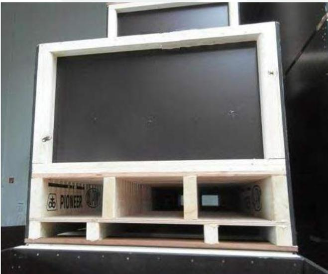
Exemple d'un palox de séchage à double palette; ventilation et transport. Extérieur du palox en «betonplex».
