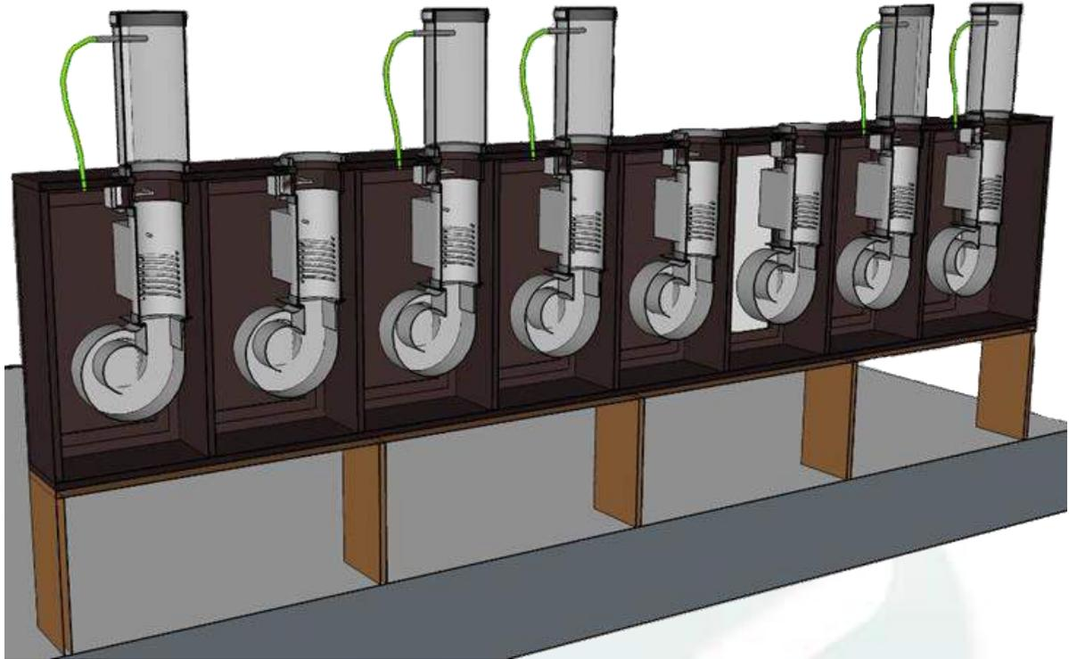
Un petit ventilateur à haute pression souffle l'air, en passant à travers un chauffage électrique dans le tube, afin de rendre la semence fluide.
