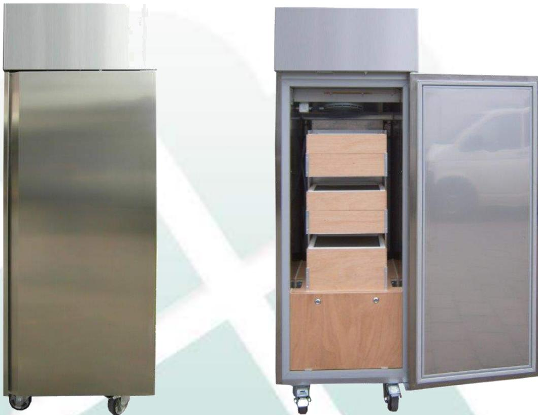
Dans l'armoire climatique, le produit est séché en 3 niveaux. Le process de séchage peut avoir lieu en plusieurs étapes (phases); pour chaque phase, la température, la quantité d'air et la vitesse d'absorption d'humidité peuvent être programmées.
