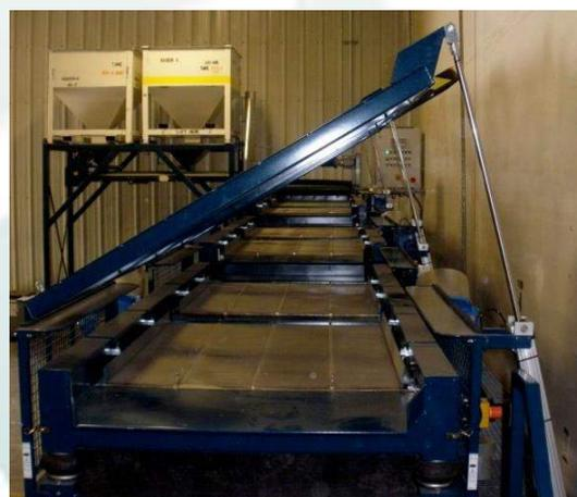
Trois unités de calibrage en ligne / alimentation de la semence avec un tapis à 90°. Le haut de l'installation est équipé de volets translucides et d'une plate-forme d'accès; le déroulement du process peut être contrôlé. Les cadres sont facilement accessibles pour le changement de tamis, par la plate-forme d'accès.
