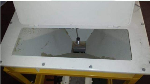
Une sonde de remplissage, située dans l'entonnoir ou le container, active l'unité pneumatique afin de maintenir à niveau dans le doseur ou trémie.
