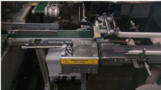
Sur une ligne de remplissage de boîtes existante, une unité de pesage auto-développé a été installée, et l'écart a été réduit à 1 g / kg de semences.
