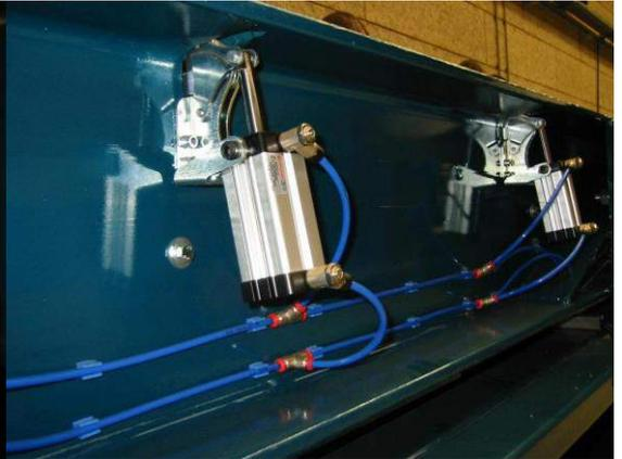
Des cylindres pneumatiques verrouillent automatiquement les tamis sur les cadres. Changement rapide des tamis.
