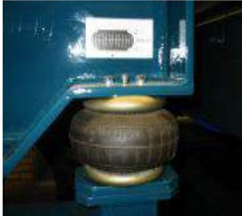
Le cadre de tamis est monté sur quatre amortisseurs d'air ou amortisseurs alternatifs.
