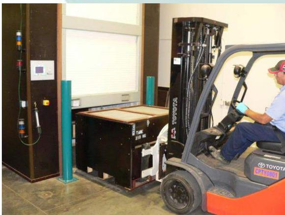
Placement de la caisse de semence dans le séchoir
