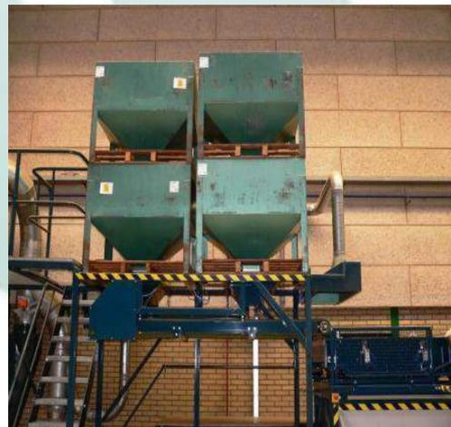
Alimentation de la semence par 2 rangées de palox-doseurs. Ceux du haut alimentent ceux du bas, cela procure une augmentation de capacité pour un process continu.
