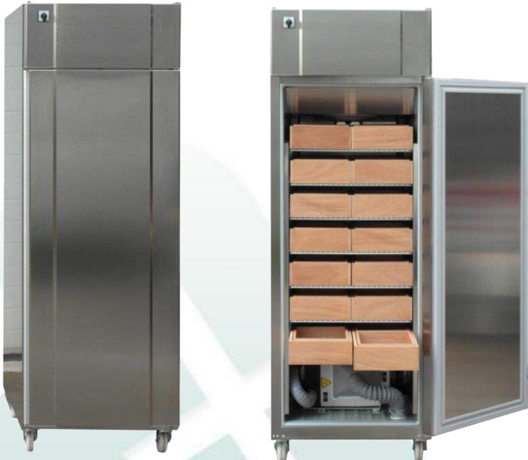
Dans une armoire séchante, les semences sont déposées en vrac ou en petits sacs dans des bacs pour être séchées et conditionnées. Le flux d'air est soufflé avec précaution à travers la semence en vrac (en bac) ou à travers les paniers avec les petits sacs.
