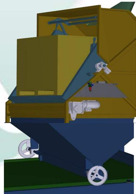
L'alimentation est réglable par un doseur en-dessous. La caisse ou octabin est bloquée, sans dommages, par une double pression mécanique.
