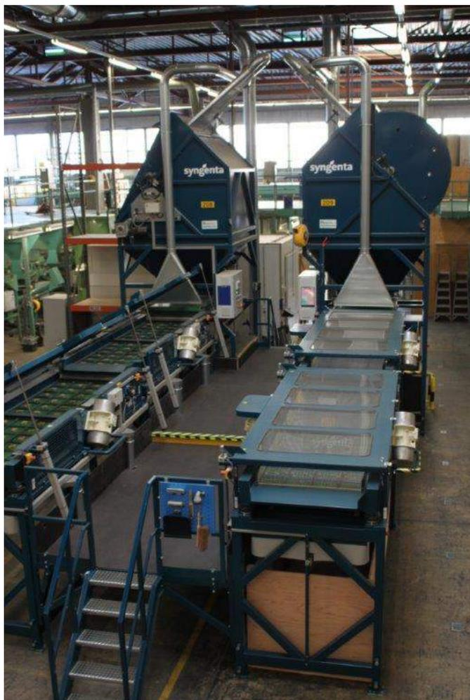
Le tri des semences s'effectue avec une calibreuse à tamis horizontal pourvue de cadres de tamisage avec des moteurs balourd ou vibreurs électriques.
