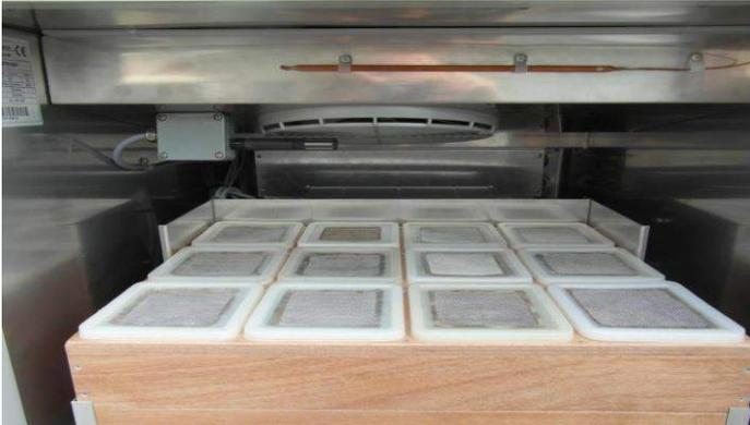
La quantité d'air par pulsation peut aussi être programmée. Les semences et pilules très fragiles sont alors alternativement en mouvement ou au repos, ce qui assure l'aération et évite l'agglomération sans crainte de dégâts et permet un séchage homogène.
