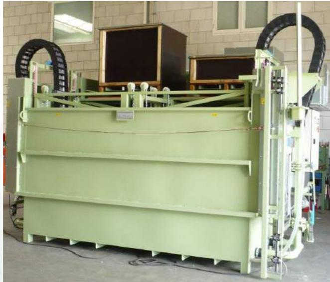
L'eau peut être chauffée de différentes manières. La température peut être réglée par un ballon d'eau chaude central électronique ou livré avec un ballon intégré. La variation en température est de l'ordre +/- 0.5 °C.
