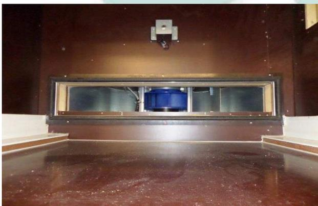
Hochdruckgebläse mit „Durchflusssensor“ für jeden Kistenplatz
