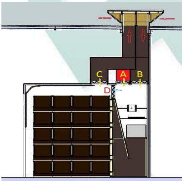
Bei der Trocknung von Saatgut kann mit erwärmter Außenluft viel Feuchtigkeit abgeführt werden. Leider eignen sich die Außenluftbedingungen nicht immer, um die gewünschte Ausgleichsfeuchte zu erzielen. Vor allem jetzt, wo immer mehr Saatgutbetriebe das Saatgut mit einem geringeren Feuchtigkeitsgehalt erhalten, lagern und verpacken möchten. Um das Saatgut schnell und gut auf den geringen Feuchtigkeitsgehalt zu trocknen, wird in der letzten Phase getrocknete Luft benötigt.
