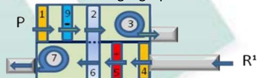
**Option II) 9:** Kaltwasserbatterie (Kühler) mit modulierender Kapazität kann die Prozessluft auf jede gewünschte Temperatur kühlen; Hybridsystem
