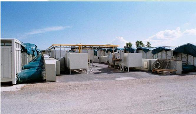
Beispiel für den Trocknungsvorgang in Containern. Der Luftstrom wird automatisch auf die Anzahl der Container abgestimmt.
