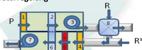
**Option I) 8:** Ein Wärmetauscher senkt die Temperatur der Prozessluft auf Umgebungsniveau + 3 °C. Mit der frei werdenden Energie wird die Regenerationsluft erwärmt und Energie gespart.
