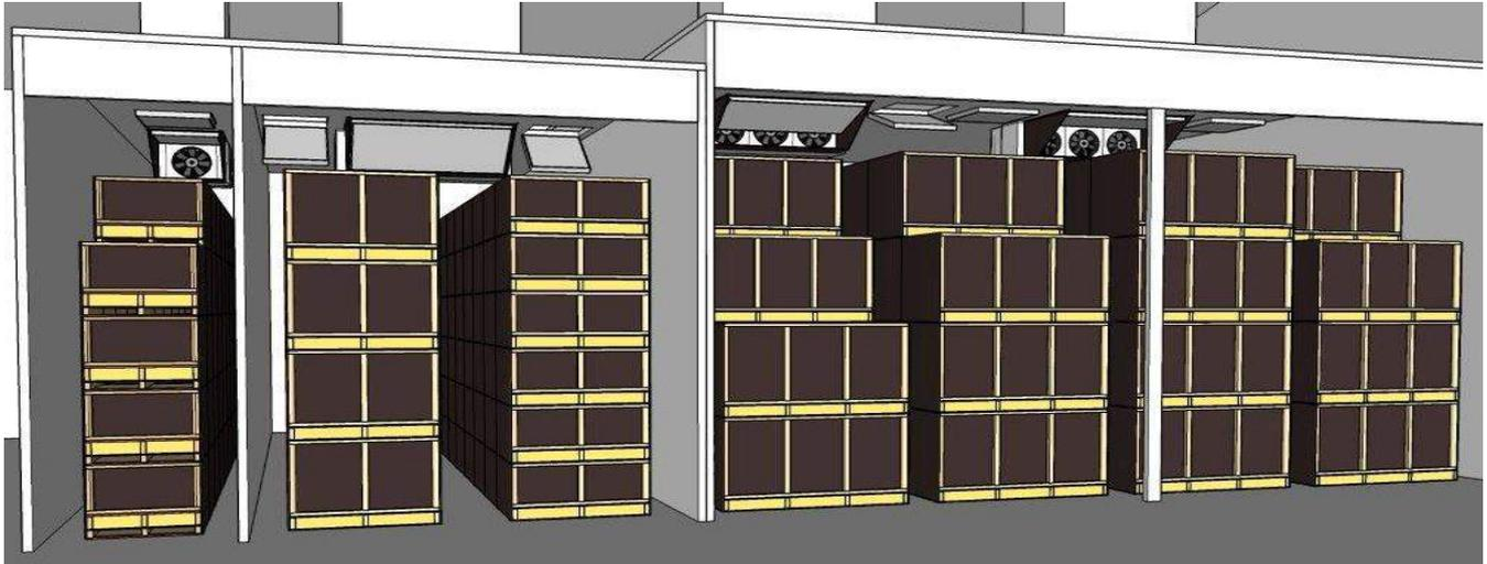
Einteilung und Abmessungen der Kammern werden je nach Wunsch und Verwendung bestimmt: 1 oder mehrere Reihen Kisten pro Kammer oder 1 große Kammer mit Trocknung auf 2 Seiten, 3/4/5/6 Kisten aufeinander gestapelt. Volumen bis 30 oder 40 m<sup>3</sup> pro Reihe sind möglich.
