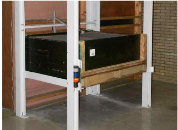
LED Lampe geben einen Hinweis von Status der Trocknung. Orange: Start trocken, blau: letzte Stufe, weiß: Trocknung fertig.
