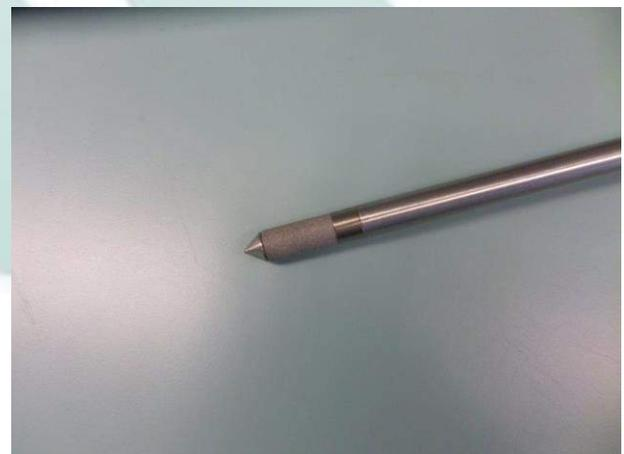
Messung von rF + T° an der Sensorspitze
