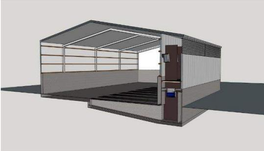
Durch Anbringung einer modularen Heizung pro Reihe wird die Temperatur an die Phase der Trocknung angepasst: zu Beginn schrittweise Erwärmung und danach optimale Trocknung bei der gewünschten Temperatur. Da auch die Luftmenge variabel ist, werden oft 2 kleinere Gasbrenner angebracht, um so einen größeren Unterschied zwischen der Mindest- (1 Brenner gering) und der Maximalkapazität (2 Brenner hoch) zu erzielen.
