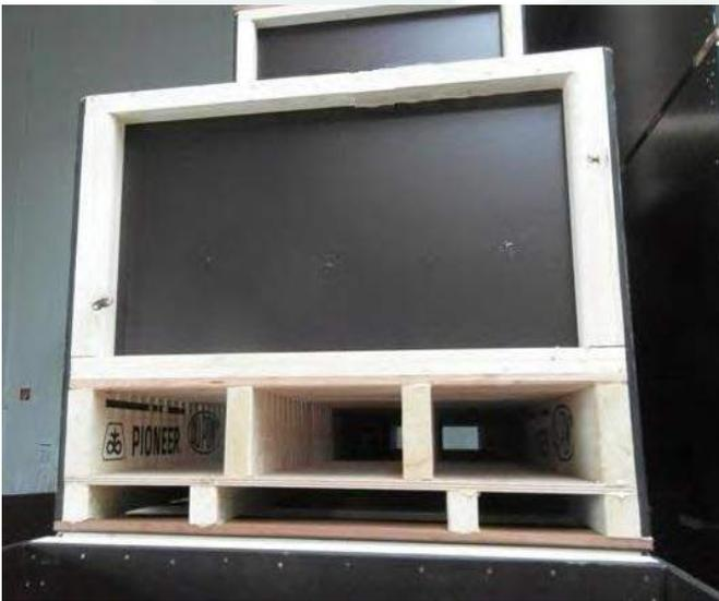
Beispiel einer Trocknungskiste mit doppelter Palette: Lüftung und Transport; Kiste mit einer Sperrholz-Außenseite.
