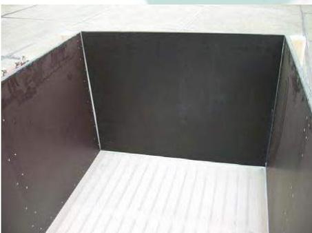
Trocknungskiste mit Lattenboden und Feinsieb an der Oberseite.
