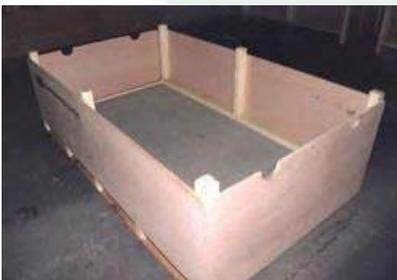
Durch Eckpfosten und Mittelverstreben im Inneren der Kiste entstehen zusätzliche Ritzen, in den sich das Saatgut sammelt. Dies erfordert dann zusätzliche Reinigungsarbeit zur Vermeidung von Verunreinigungen.
