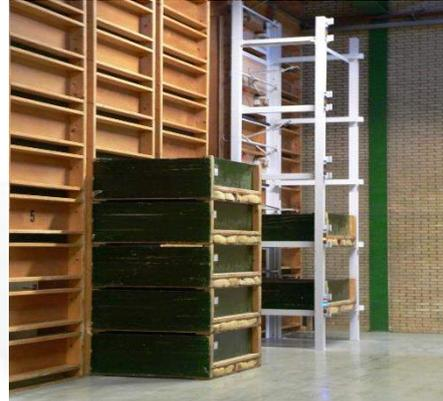
Beispiel für die Nachrüstung einer bestehenden Trocknungsanlage mit Kisten. Die Kisten mit dem Saatgut können einzeln auf den gewünschten Feuchtigkeitsgehalt getrocknet werden.
