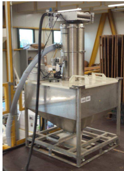
Saatgutzufuhr durch eine Vakuumeinheiten mit Trichterbehälter.
