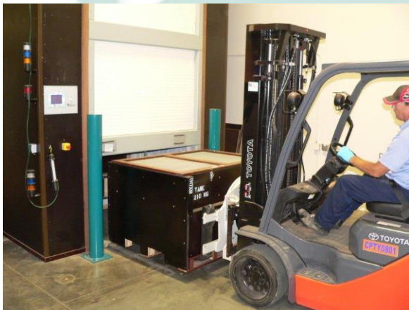
Droogkist met zaad wordt in de drooginstallatie geplaatst
