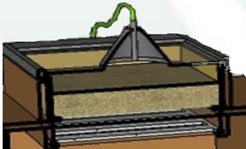
Der T°- und der rF-Messsensor (c) sind mit einem Trichter auf dem Abdeckgitter montiert und messen die Eigenschaften der aus dem Saatgut kommenden Luft.
