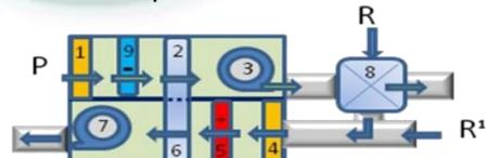
**Opción III) 8+9:** Combinación 8+9: Ahorro de energía y se logra cada T°C deseada para aire de proceso saliente. Sistema híbrido con intercambio de calor.
