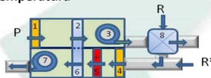
**Opción I) 8:** La unidad de intercambio de calor bajará la T° del aire de proceso hasta el nivel de ambiente del + 3°C. La energía libre entrante será usado para calentar el aire de regeneración; un ahorro de energía.
