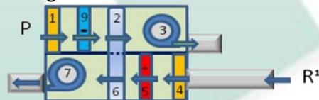
**Opción II) 9:** Una batería de agua fría (enfriador) con capacidad modular puede enfriar el aire de proceso hasta cualquier T°C deseada. Sistema híbrido.
