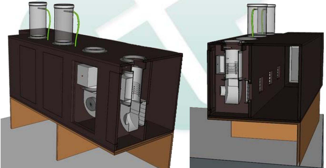
Luft wird durch einen zentralen Kanal auf der Rückseite entzogen; frische und trockene Luft, um zu vermeiden, dass feuchte Luft wiederverwendet wird.
