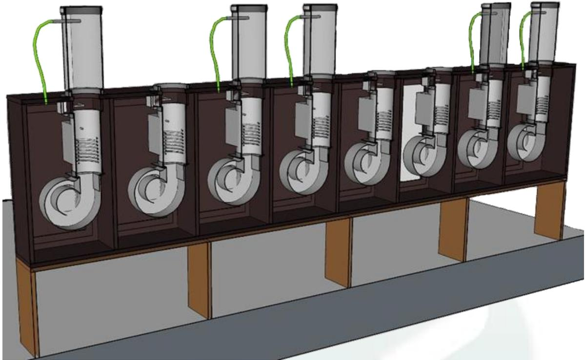
Ein kleiner Hochdruckventilator bläst die Luft durch eine elektrische Heizung in das Rohr, um das Saatgut in Bewegung zu versetzen.
