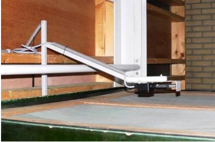
Sensor im Abluftstrom einer Trocknungskiste. Messung von T^\circ und rF pro Abschnitt (Kasten, Tray, Container).
