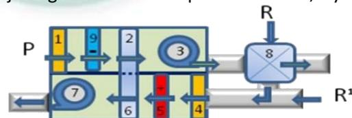
**Option III) Kombination aus 8+9:** energiesparend, jede gewünschte Temperatur bei ausströmender Prozessluft möglich; Hybridsystem mit Wärmeaustausch
