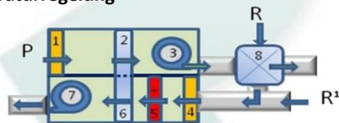
**Option I) 8:** Ein Wärmetauscher senkt die Temperatur der Prozessluft auf Umgebungsniveau + 3 °C. Mit der frei werdenden Energie wird die Regenerationsluft erwärmt und Energie gespart.
