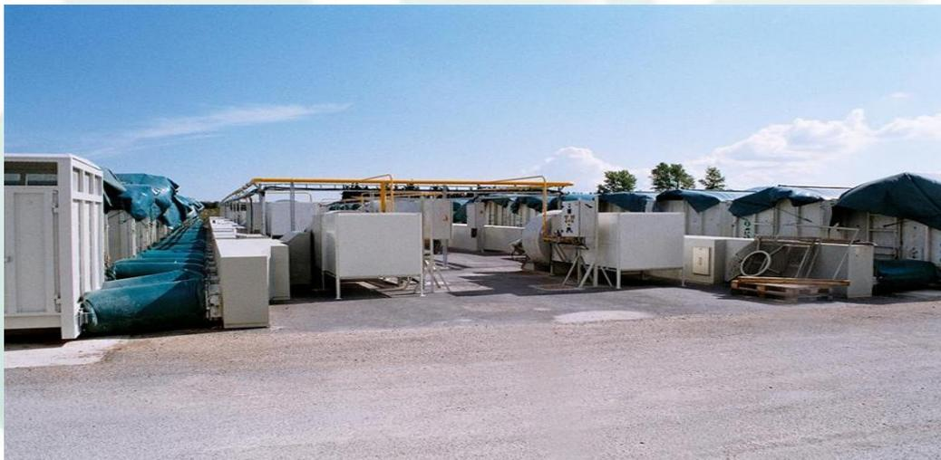
Trocknungsabschnitte mit Gebläse, Luftverteilkanal und Anschlüssen an die Container
