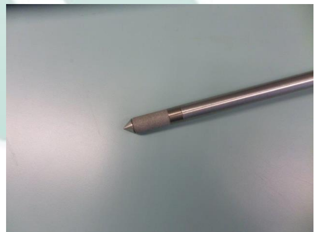
Messung von rF + T° an der Sensorspitze
